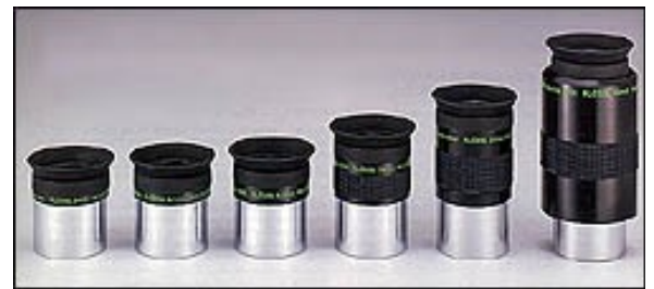
Προσοφθάλμιοι φακοί διαφόρων εστιακών αποστάσεων της Meade. Οι μικρότεροι από αυτούς προσφέρουν τις μεγαλύτερες μεγεθύνσεις και οι μεγαλύτεροι προσφέρουν τις μικρότερες μεγεθύνσεις.
